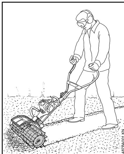
Мультиинструмент подметальный валик KW-MM служит для уборки поверхностей и дорожек, сметания влажного мусора, как, например, влажной листвы либо грязи, уборки снега, удаления воды.
