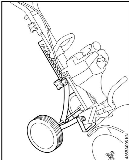
Использование набора колёс облегчает работу с использованием подметального инструмента – см. также указания к разделу "Колёса" в инструкции по эксплуатации мультидвигателя.
