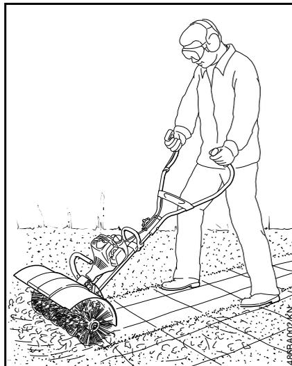
Мультиинструмент подметальная щётка KB-MM служит для чистки поверхностей и дорожек, также при наличии неровных поверхностей и поверхностей с расшитыми швами и полов из натурального камня.
